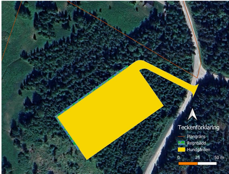
Figur 8-3. Förslag på placering av regnbädd/krossdike i förhållande till hunduppfödningssområdet.
