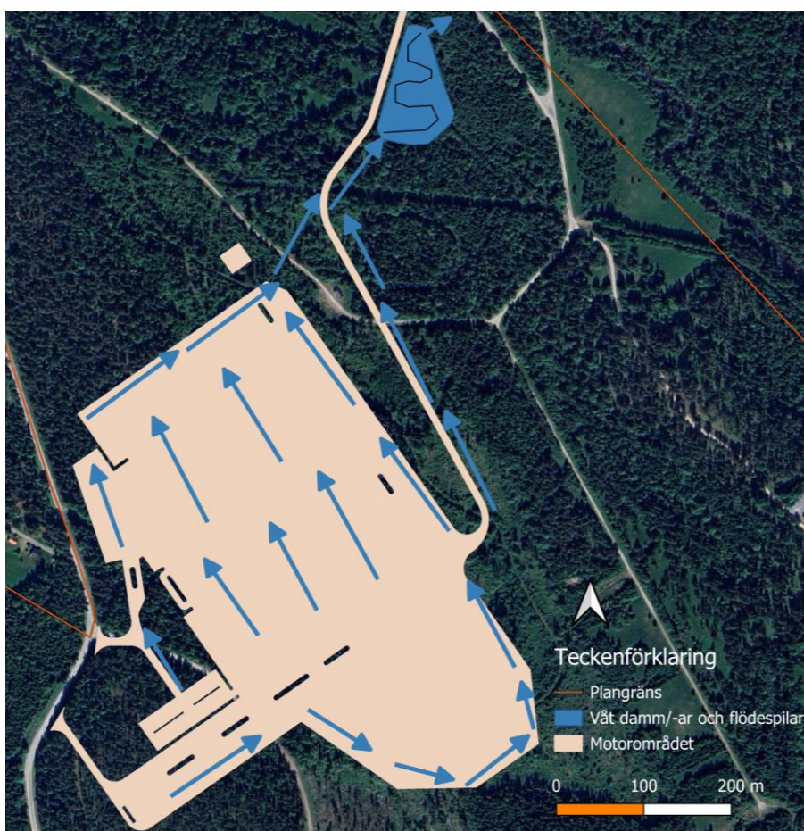
Figur 8-2. Principskiss över förslag på placering av anläggning för fördröjning av dagvatten, med pilar som visar föreslagna rinnvägar. Våtdammen i figuren motsvarar en area på ungefär 7 500 m 2 .
