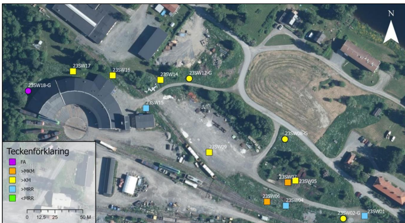
Figur 10: Illustration av provpunkterna som ingick i Swecos undersökning 2023. Provpunkterna är färgkodade utifrån analysresultat av jord. Här har Naturvårdsverkets generella riktvärden och nivåhalter (2022 och 2013) samt Avfall Sveriges gränsvärden för farligt avfall (2019) används. Klassningen är gjord efter högsta uppmätta halt från samtliga analyserade nivåer i provpunkten.
