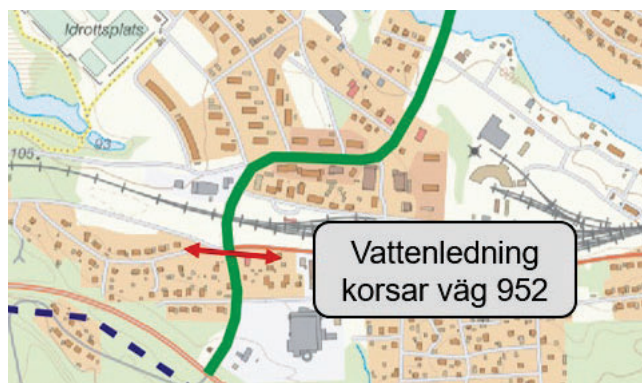
Figur 7 Vattenledning vid södra järnvägsstationen
